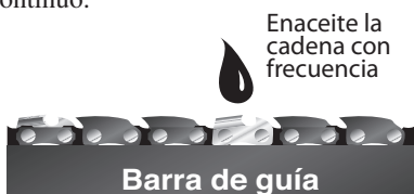
Figura 12 - Aplicación de aceite a la cadena
